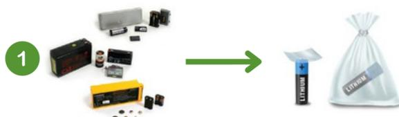
Protégez les bornes en plaçant la pile ou la batterie dans un sac en plastique transparent ou en recouvrant la borne positive avec du ruban adhésif d'emballage, du ruban à conduits ou du ruban électrique.
